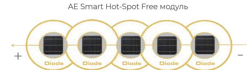
Hot-Spot Free технология защищает каждую ячейку индивидуальным обходным диодом
